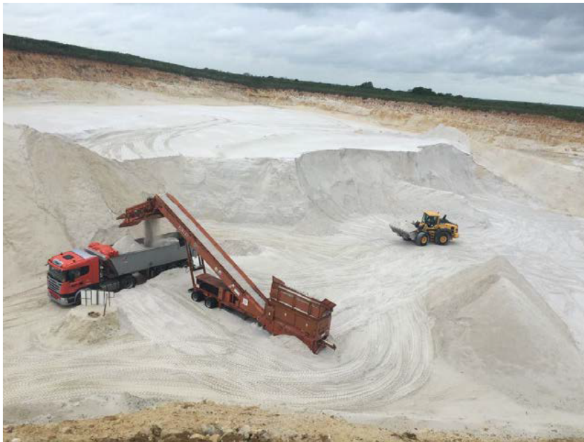
Illustration : Criblage mobile et chargement des camions au carreau de la carrière (source : demande d'autorisation, résumé non technique)
